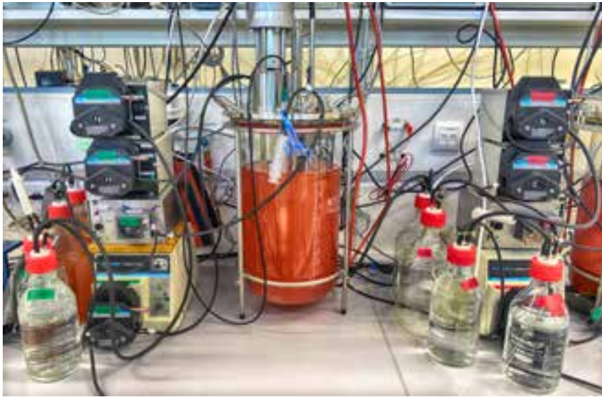
Onderzoeksofstelling van de Radboud Universiteit Nijmegen (groep Mike Jetten) voor het zuiveren van afvalwater. Het reactorvat in het midden bevat de rode anammoxbacterien die het (synthetische) afvalwater met ammonium zuiveren.
